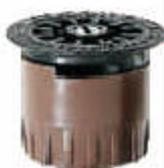
Как видно из выделенной строки, данное сопло 7170 с регулируемым сектором полива при распылении воды на 360° и при рабочем давлении 2 BAR обеспечивает дальность полива – 2.4 м и при этом через него выливается 5.1 л/мин (0.31 м<sup>3</sup>/час)
